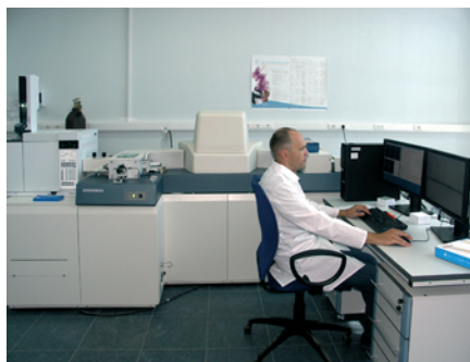
Хромато-масс-спектрометр высокого разрешения Autospec Premier для анализа особо опасных химических загрязнителей
